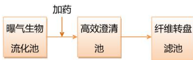
图7-1 珠江污水处理厂污水处理工艺流程图
