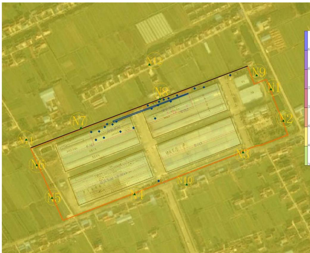
图 5.3-3 项目夜间噪声预测值等值线图（设置隔声墙后）
