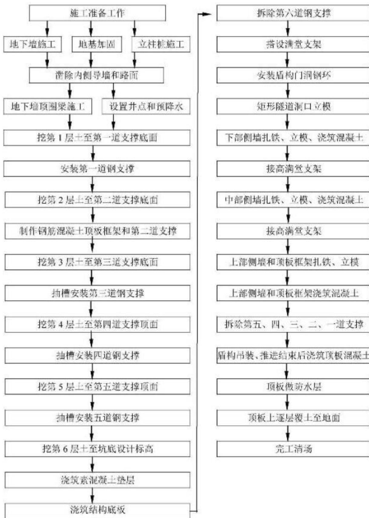
图 2-1-15 工作井施工流程示意图
