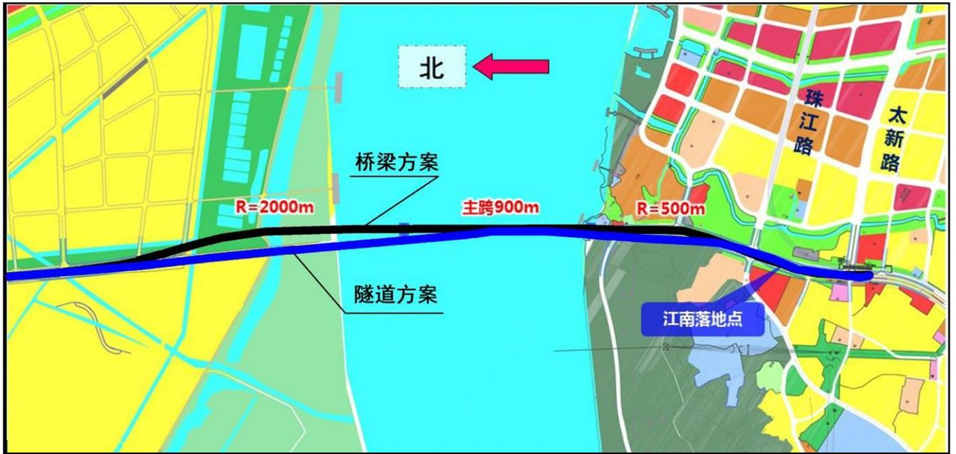
图 3-1-1 隧道方案和桥梁方案路线走向示意图
