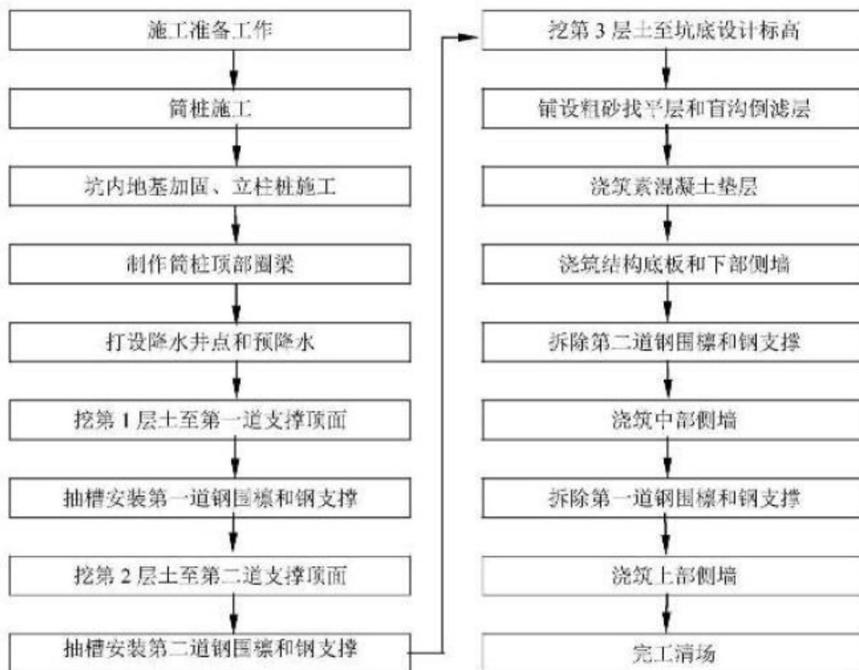
图 2-1-17 敞开段施工流程示意图
