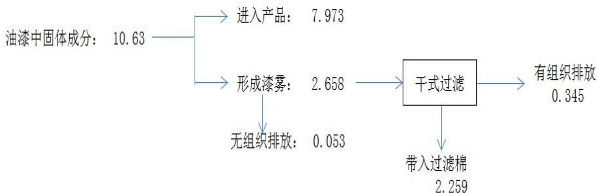
图 4.3-11 油漆固体成分物料平衡图 (t/a)
