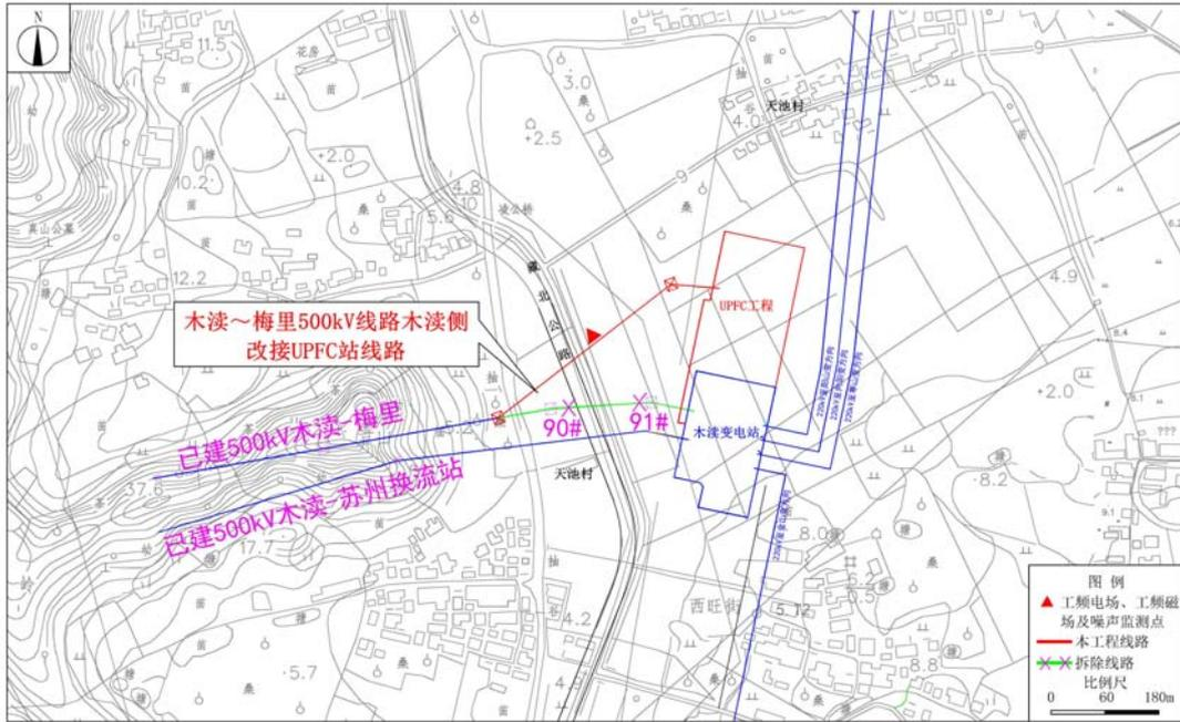
图 3.6 木渎~梅里 500kV 线路木渎侧改接 UPFC 站线路路径示意图
