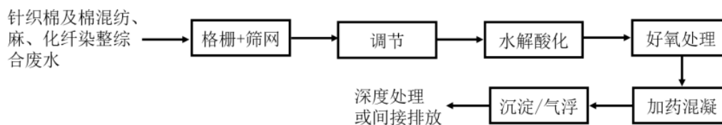
图 7.1-3 化纤染整的综合废水常规处理工艺流程示意图（HJ471-2020）
