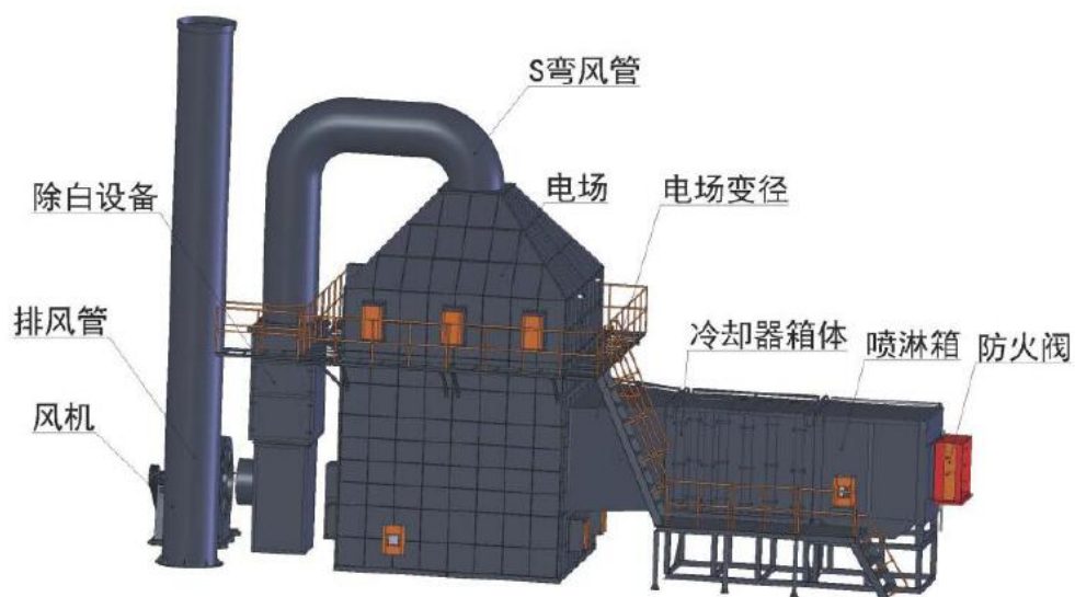
图 7.2-4 “水喷淋+静电净化”设备示意图
