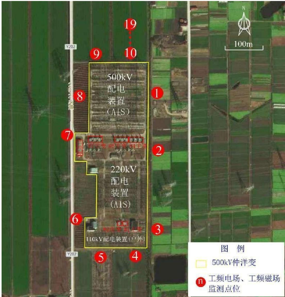
图 6.1 类比南通仲洋 500kV 变电站站界监测点位布置示意图
