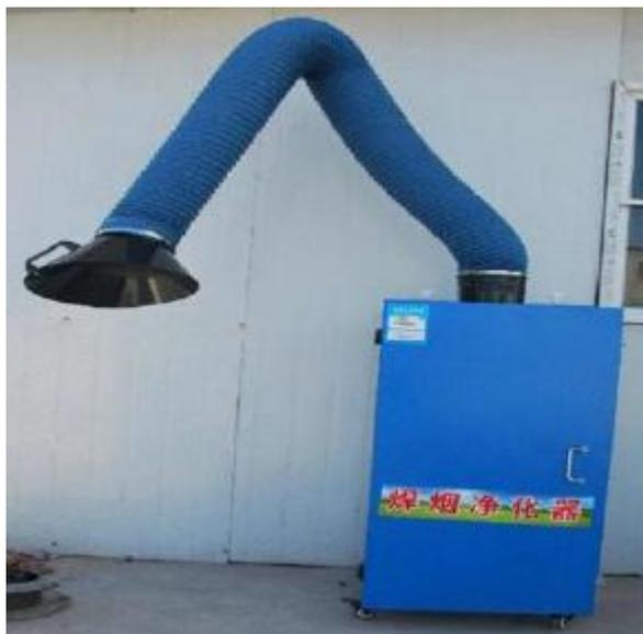
图 6.2-2 本项目移动式焊接烟除尘器设施图
