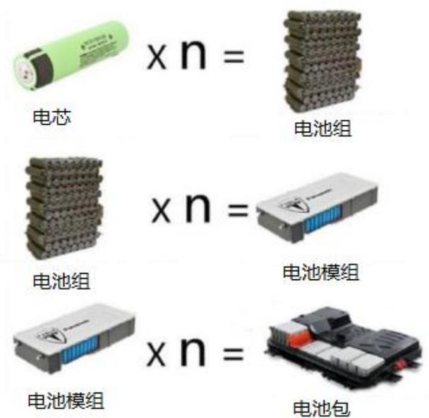
图 3.1-1 典型汽车动力锂电池的构成示意图
