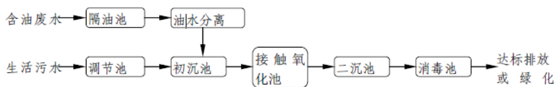
图 6.7-1 后方分销转运站现有污水处理站工艺流程图
