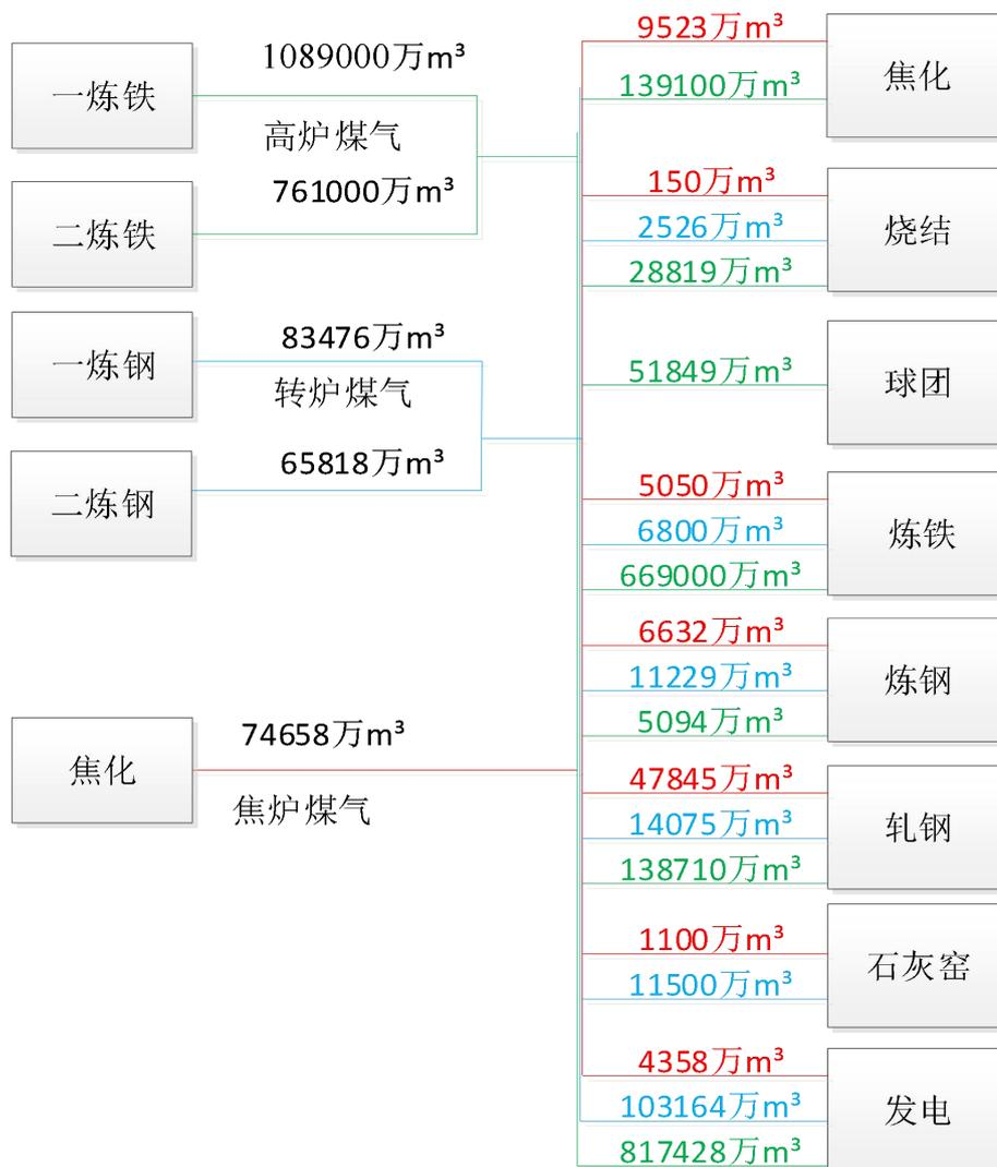
图 3.6-1 现有项目煤气平衡图（单位：万 m³/a）
