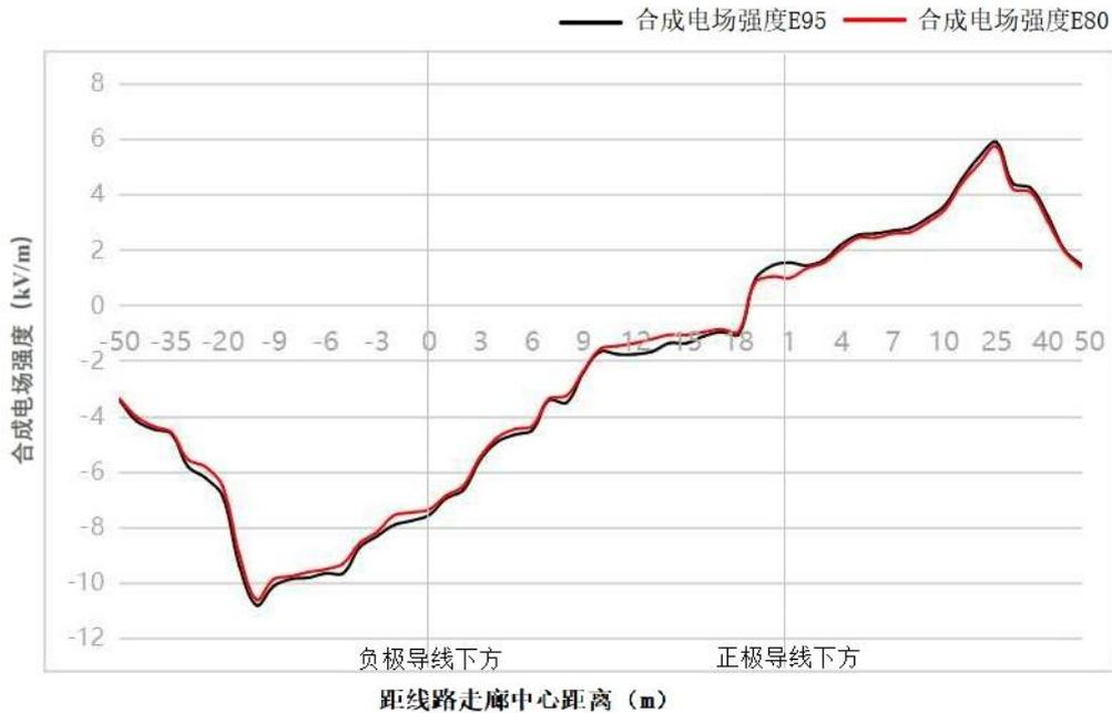
图 7.1-2 ±800kV 锡泰线类比监测合成电场分布图
