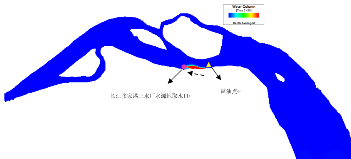
图 6.5-3 (a) 刚落潮时浦沙码头及海力 2#码头 7 万吨泊位发生碰撞事故燃料油泄漏油膜到达长江张家港三水厂水源地取水口
