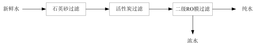
图4.3-1 纯水制备工艺
