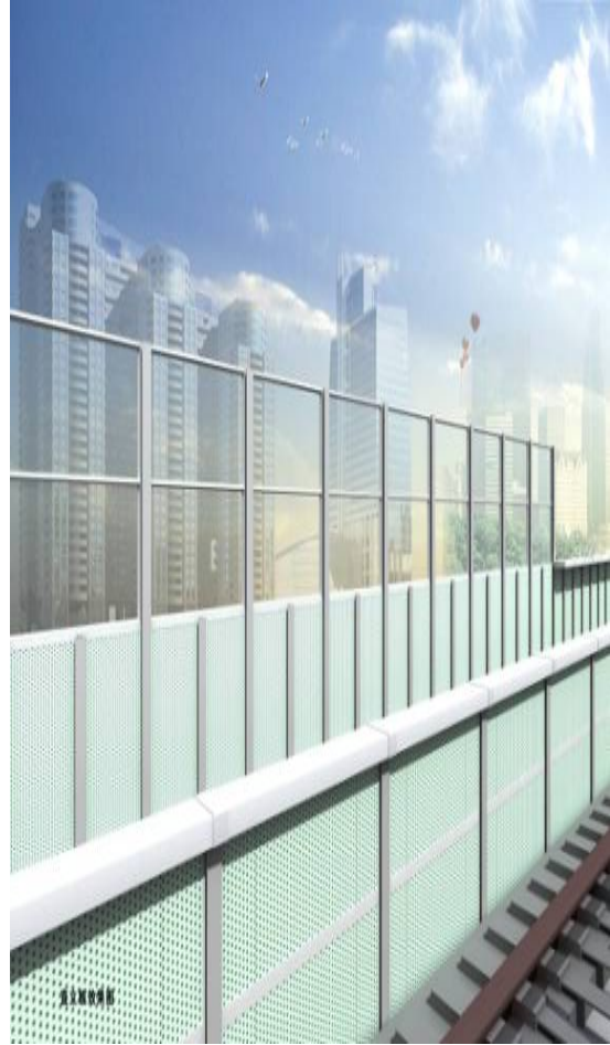
图 4.5-1 直立式声屏障示意图
