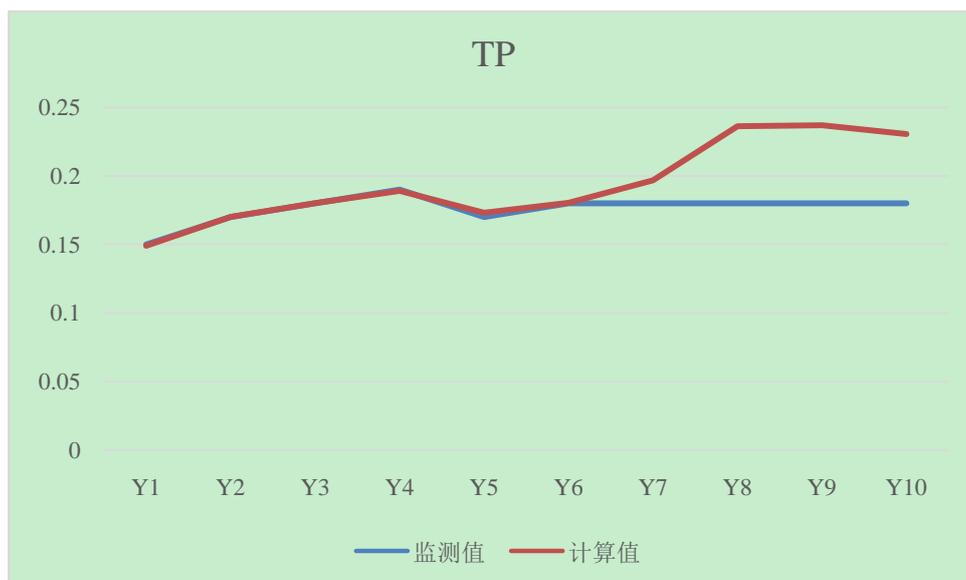
图 6.1-5 各断面水质实测值与计算值对比图
