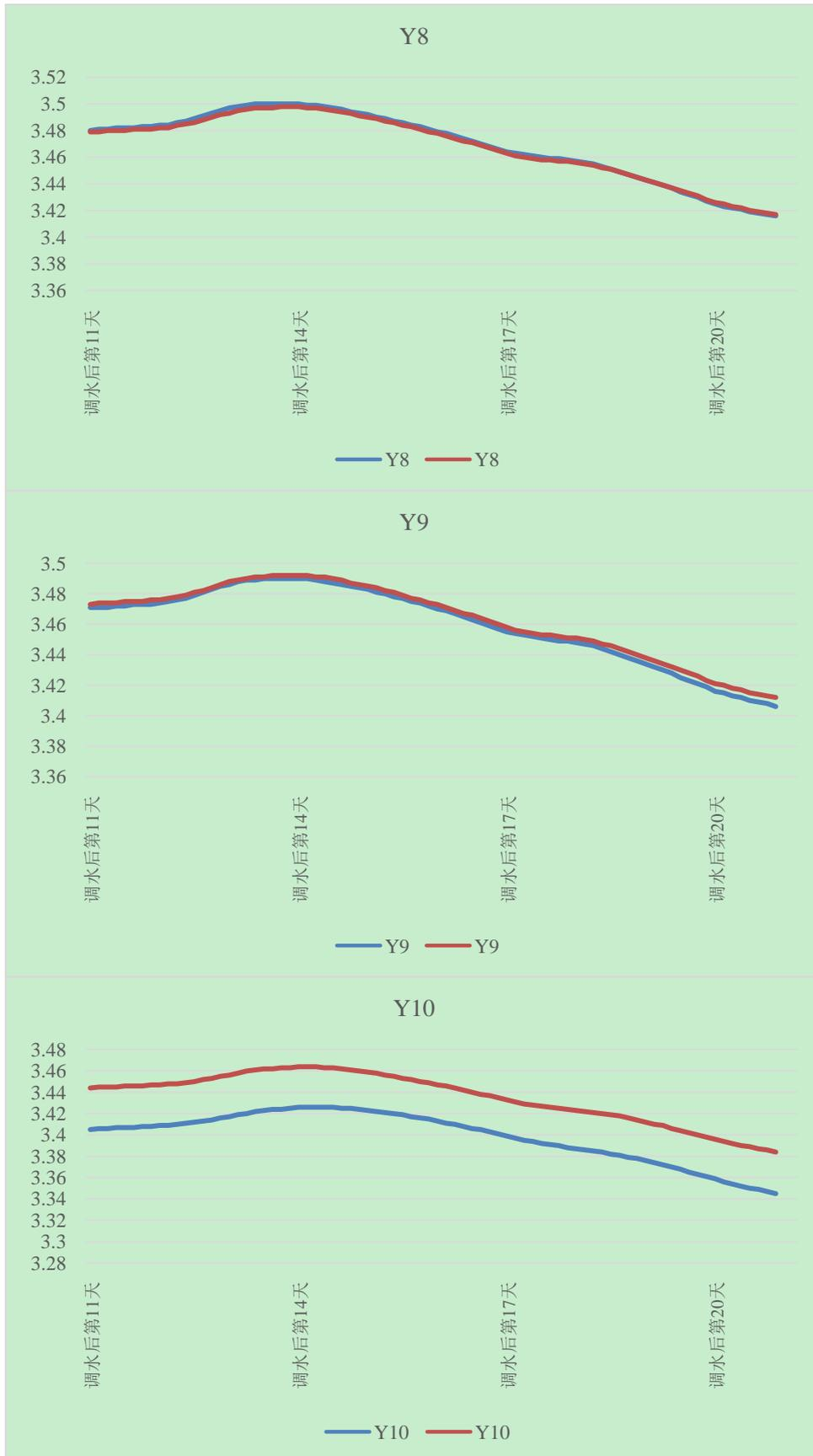
图 6.1-8 工程实施前后河道断面水位过程线对比图
