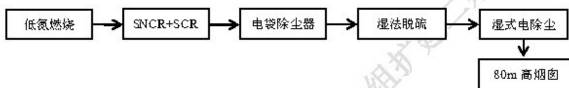
图 7.2-1 烟气处理工艺流程图
