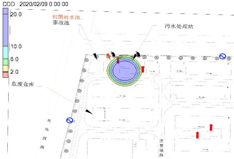
6.5.5-1 (a) 非正常状况下污水处理站运行 100 天后 COD 运移平面分布图
