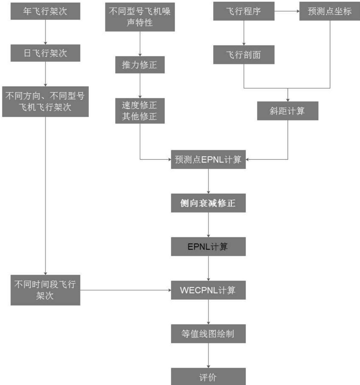
附图 5.2.3-1 飞机噪声预测程序图
