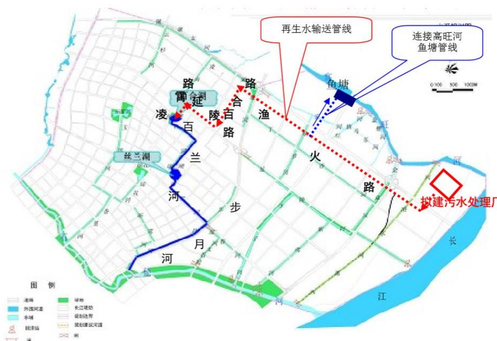
图 3-2-2 尾水回用于开发区河湖路线及与高旺河鱼塘连接线路图
