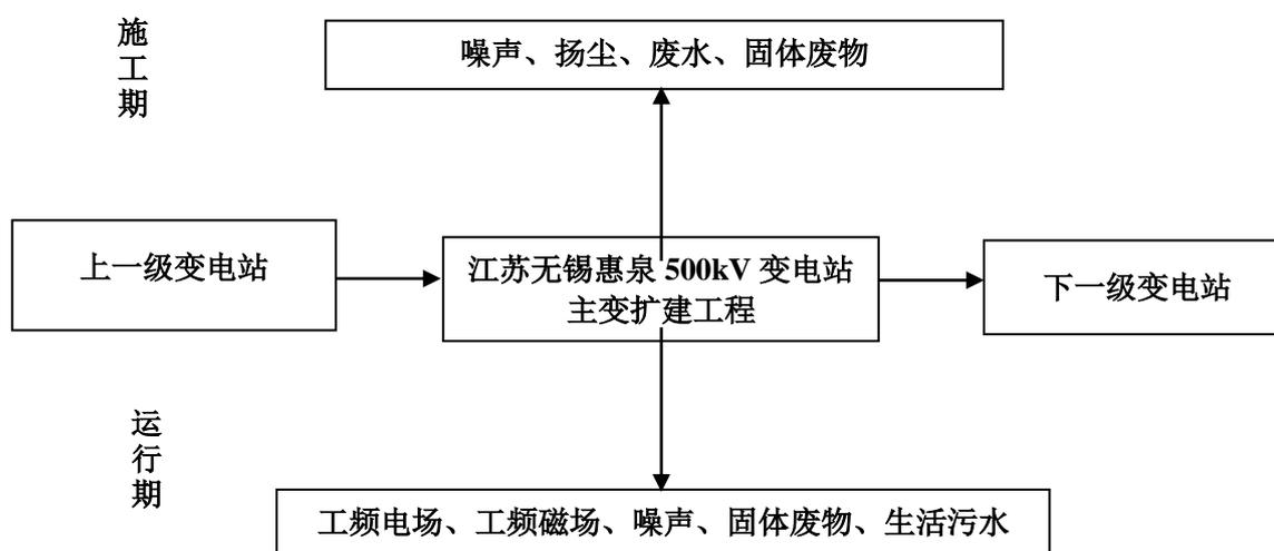
图 3.7 本工程工艺流程与主要产污环节示意图
