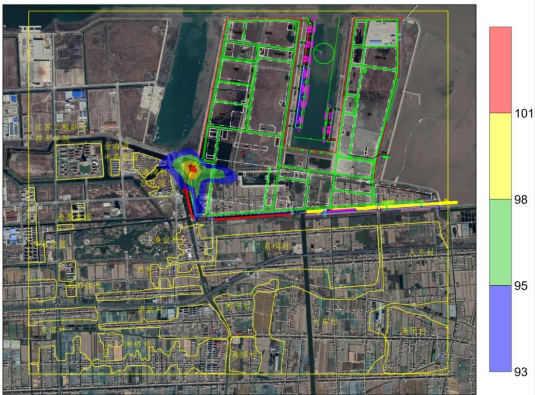
图 5.1-8 本项目叠加背景值后  $\text{PM}_{10}$  保证率日均浓度贡献值分布图 (单位:  $\mu\text{g}/\text{m}^3$ )
