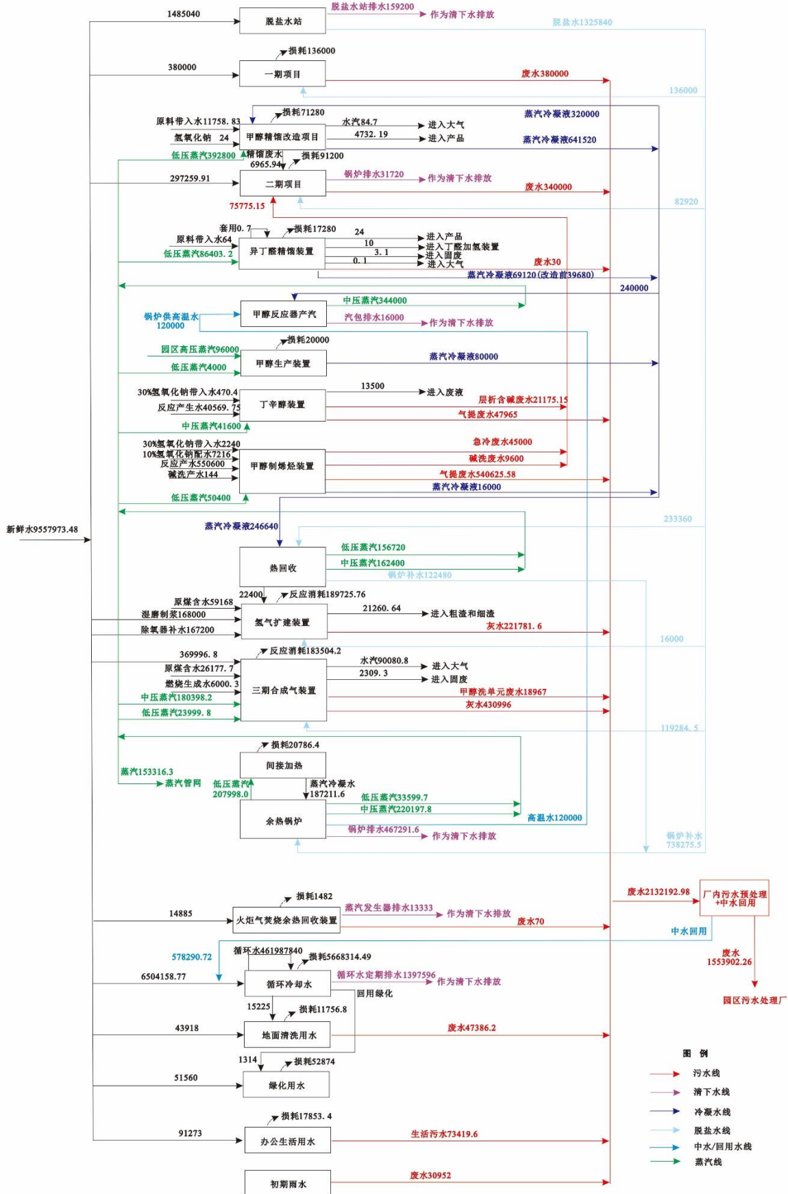
图 4.2-11 本次项目实施后全厂水平衡图 (m³/a)
