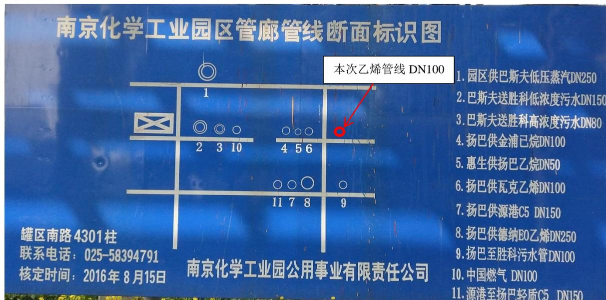
图 4.1-3 本次乙烯管线布置位置与公用管廊上其他管线断面示意图
