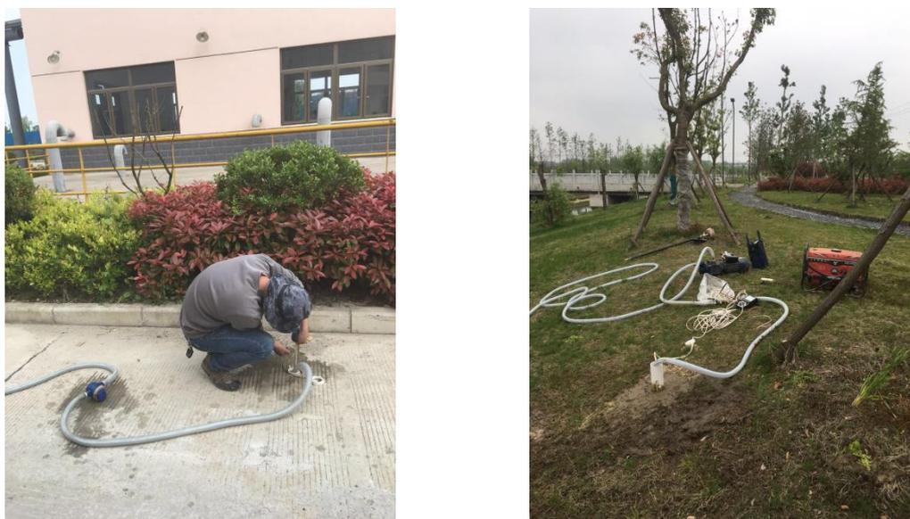
图 xx 潜水井注水试验现场照片
