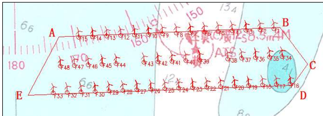
图 13.5-6 江苏大丰 H8-2 海上风电场最终风机布置图
