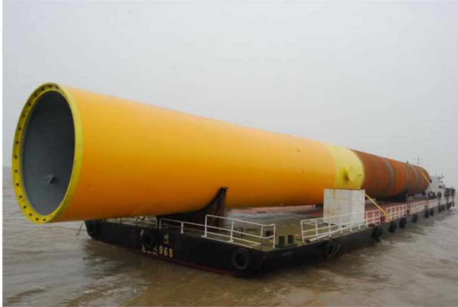
图 3.6-3 单桩钢管桩运输
