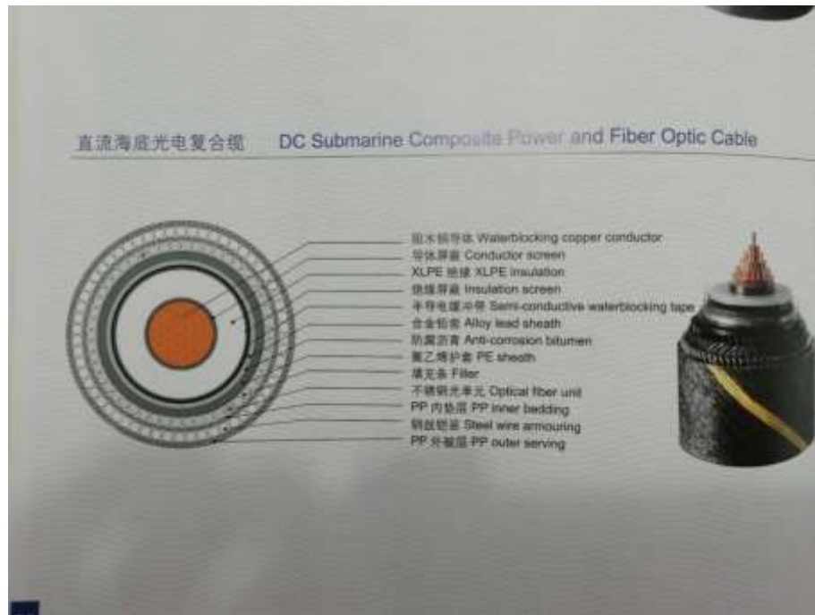
图 3.4-12 320kV 海底电缆剖面结构示意图
