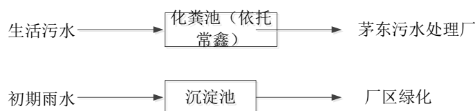
图 6.2-1 废水处理工艺流程图
