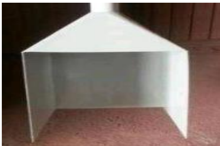
图 3.3-2 半密闭式集气罩示意图
